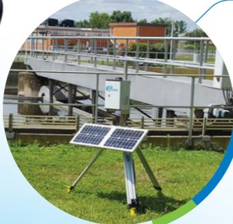
Réseaux de micro-capteurs autonomes pour mesurer en temps réel les gaz odorants, suivre l'évolution de la qualité de l'air, établir des cartographies environnementales de sites... Sensor-based air quality micro-stations for odor monitoring, fugitive emissions detection, environmental impacts surveys...
