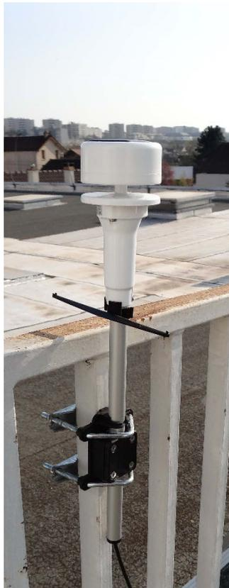
Figure 1-1 – Présentation de l'anémomètre installé
