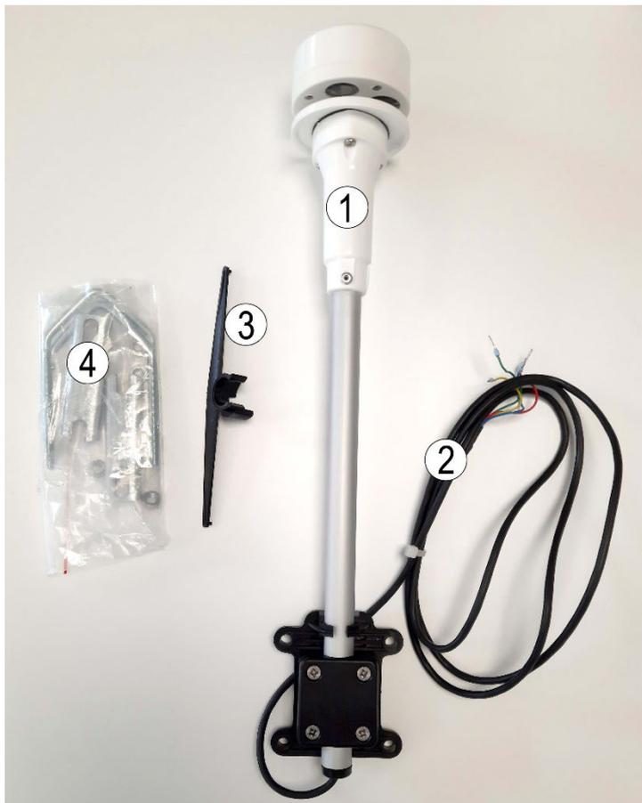
(1) Anémomètre, (2) câble, (3) mire d'alignement, (4) système de fixation sur mât
