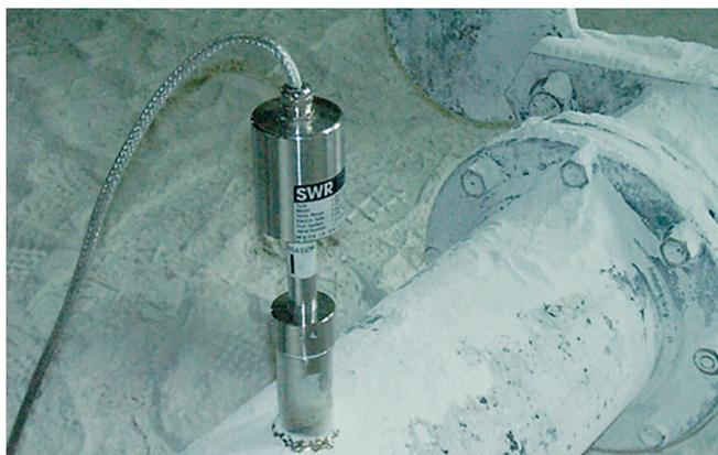
SolidFlow 2.0 se caractérise par un montage facile et sans usure. SolidFlow 2.0 est la nouvelle génération de mesure de débit de solides basé sur la technologie micro-ondes.
