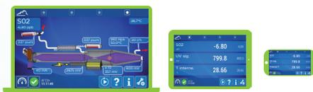
Adoptez la version sans écran et évitez la pollution liée au cycle de fabrication et de recyclage des écrans. L'analyseur est connecté à votre appareil (ordinateur, tablette ou smartphone). Accès à distance à plusieurs écrans simultanément via Wifi ou Lan en utilisant l'application dédiée ENVEA Connect™ pour le contrôle, le diagnostic, la mise à jour du logiciel, etc.
